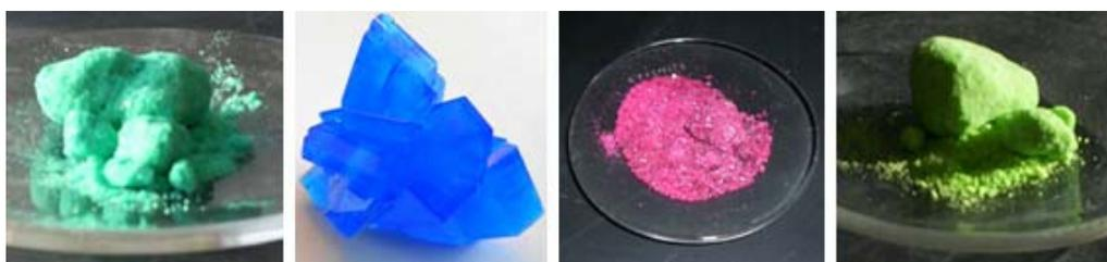
Fig. 5.1. Algunas muestras pueden identificarse por su color (de izquierda a derecha:  $\text{CuCl}_2 \cdot 2\text{H}_2\text{O}$ ,  $\text{CuSO}_4 \cdot 5\text{H}_2\text{O}$ ,  $\text{CoCl}_2 \cdot 6\text{H}_2\text{O}$  y  $\text{NiCl}_2 \cdot 6\text{H}_2\text{O}$ ).
